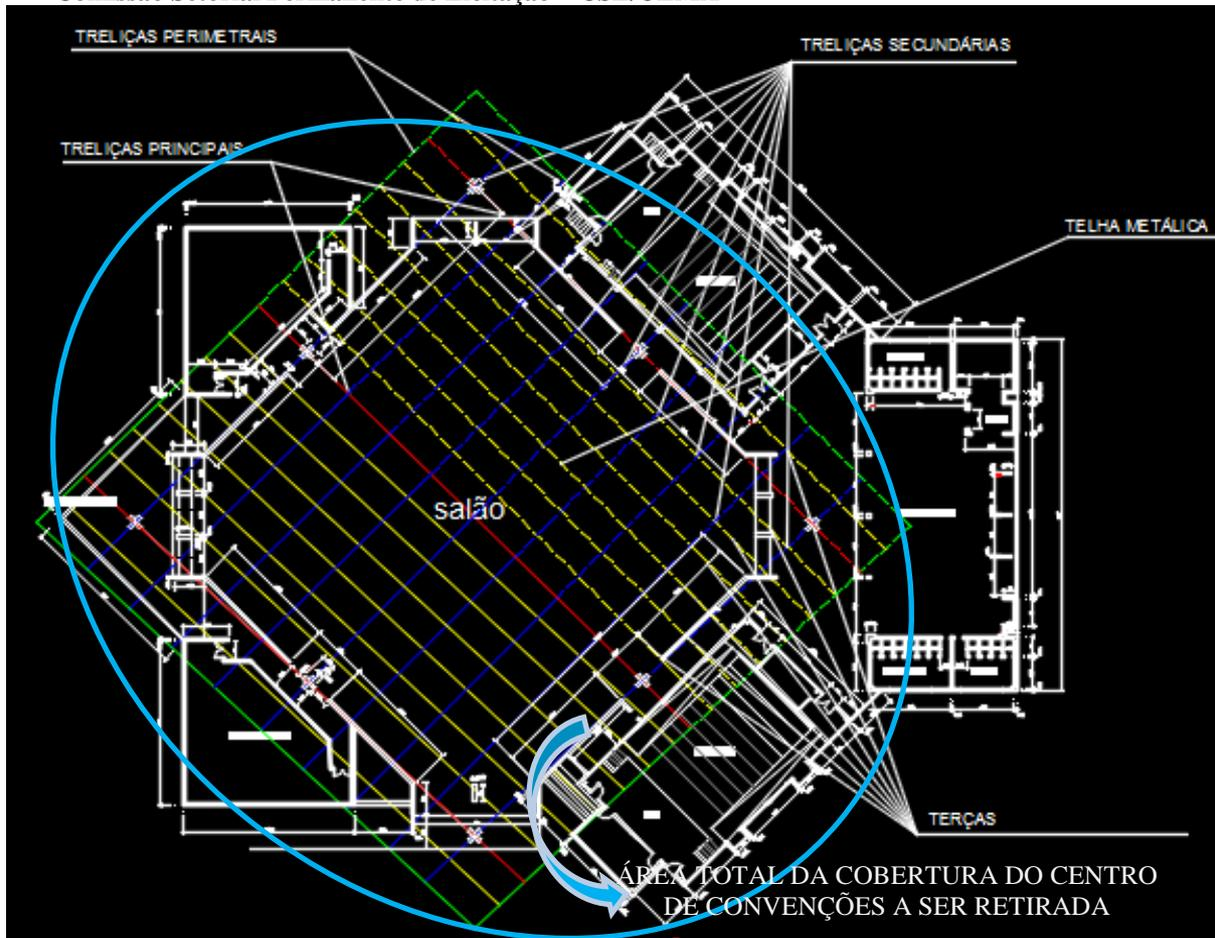
Figura 15 – Área em planta a ser removida
